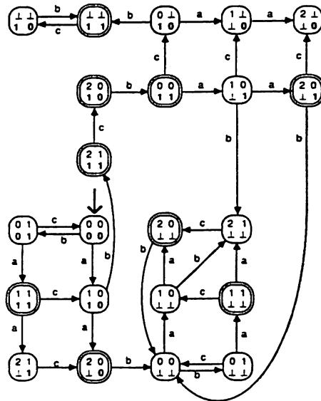
Figure 6 Automate reconnaissant l'union des langages des automates 4 et 5
