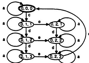
**Figure 10** Automate de mixage  $Q_1 \sqcap Q_2 \sqcap Q_3$  reconnaissant  $[cdeadc]^*$
