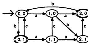
**Figure 3** Automate asynchrone déterministe
